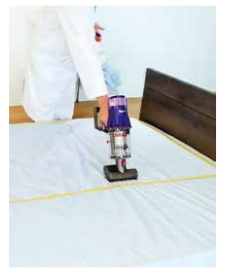
写真1 調査の様子 寝具(ベッドマット)の表面を掃除機で吸引し、ダストとダニを捕集
