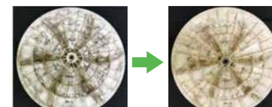
写真3-A 酸素系クリーナーで洗浄したパルセーター (左: 洗浄前、右: 洗浄後)
