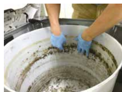
写真1 カビが生えた洗濯機の外槽
