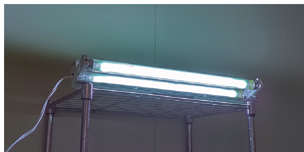
図1 試験品として用いた殺菌灯 ※2本に見えるが1本は鏡面反射
