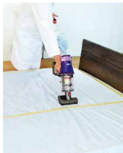
写真1 調査の様子 寝具(ベッドマット)の表面を掃除機で吸引し、ダストとダニを捕集
