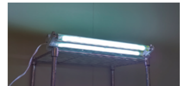
図1 試験品として用いた殺菌灯 ※2本に見えるが1本は鏡面反射
