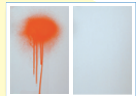
ミストは広範囲に広がるが液だれするものもあれば(左)、細かいミストで全く濡れないものも(右)
